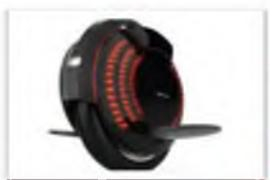
Электрическое самобалансирующееся средство передвижения с одним колесом, по бокам которого крепятся подножки.
